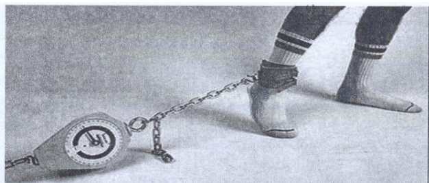
شکل ۴-۵. کابل تنسیومتر برای اندازه گیری قدرت ایستا
